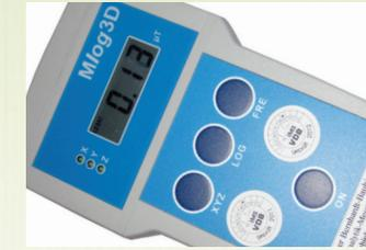
Durch Langzeitaufzeichnungen wird die magnetische Flussdichte (nT) sowie die dominierende Frequenz (Hz) bestimmt. Die durchschnittliche Belastung im Untersuchungszeitraum wird als
