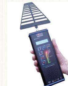
Die Belastung durch hochfrequente Felder wird durch die frequenzselektive Messung der elektromagnetischen Strahlungsdichte ( $\mu\text{W}/\text{m}^2$ ) ermittelt. Bei Bedarf werden entsprechende Handlungsempfehlungen gegeben.
