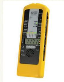
Bei elektrischen Feldern werden die elektrische Feldstärke (V/m), die Körperspannung des Menschen im elektrischen Feld (mV) und die dominante Frequenz (Hz) gemessen. Die Verursacher werden aufgespürt und Empfehlungen für eine Minimierung der Belastung gegeben.
