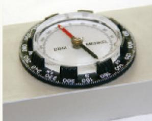
Die magnetischen Gleichfelder werden über die statische magnetische Flussdichte ( $\mu\text{T}$ ) und die Kompassabweichung ( $^\circ$ ) an Daueraufenthaltsplätzen wie dem Bett oder dem Arbeitsplatz bestimmt.
